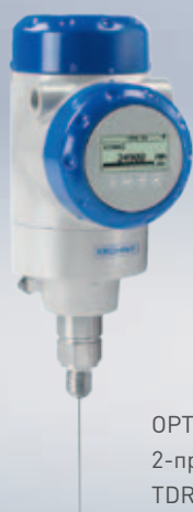
OPTIFLEX 1100 C 2-проводный радарный TDR-уровнемер с волново- дом для емкостей хранения и стандартных технологи- ческих применений
