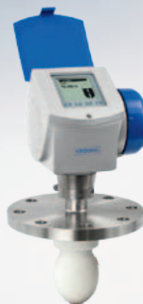
OPTIWAVE 6300 C/7300 C/ Капельная антенна 2-проводный радарный FMCW уровнемер с подфланцевой защитной пластиной для коррозион- ных сред
