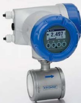
OPTIFLUX 7300 C «сэндвич»-версия С ёмкостными электродами, не контактирующими с измеряемой средой, и керамической футеровкой
