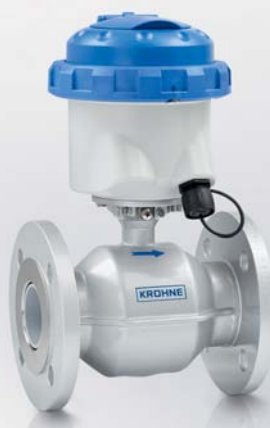
WATERFLUX 3070 Работающий от аккумуляторной батареи расходомер для больших динамических диапазонов и для условий ограниченного простран- ства без необходимости прямых участков на входе и выходе
