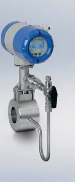
OPTISWIRL 4070 C фланцевая версия OPTISWIRL 4070 C «сэндвич»-версия Универсальный прибор со встроенной компенсацией по температуре для насыщенного пара и опционально до- ступной компенсацией по давлению для перегретого пара, газов, влажных газов
