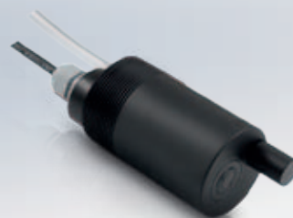
OPTISENS TUR 2000 датчик преломленного на 90° света для измерения мутности с долговечным светодиодом, работающим в ИК области спектра и с автоматической очисткой
